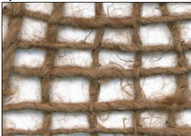
Figura 90. Tipologie di biostuoie. a) fibra in juta, b) fibra di cocco
